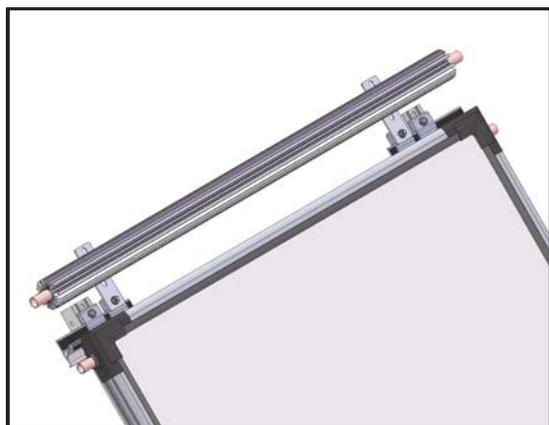
Apertar os parafusos de forma suficientemente forte, para que se aguentem, mas não fixa-los, uma vez que mais tarde, se dará o angulo de caída do dissipador
